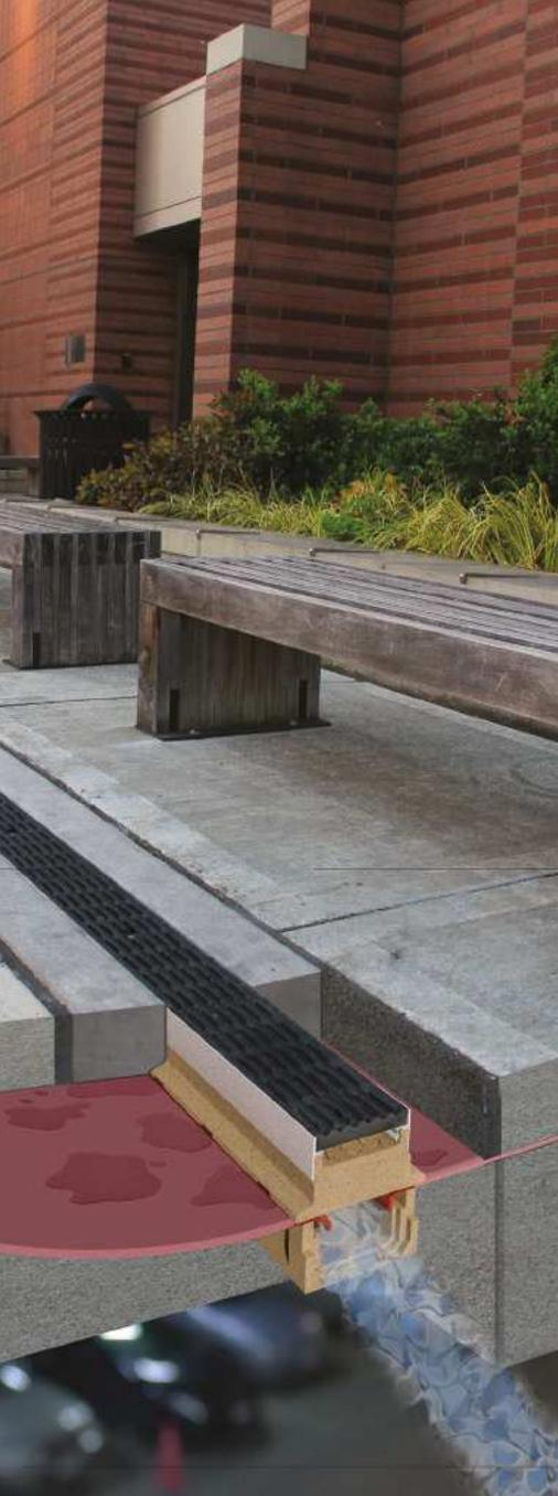
**La membrana** se sujeta entre el canal y la sub-estructura. El espesor máximo de la membrana que se puede instalar es de 12.7 mm (½"). Es importante verificar que las ranuras no estén obstruidas por la membrana en la verificación post-instalación. Los líquidos que se filtran a través del pavimento son retenidos por la membrana y drenados al canal.
